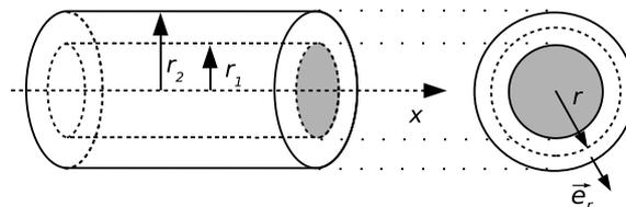
Le coeur en cuivre est parcouru par un courant électrique d'intensité  $I$  uniformément réparti dans une section droite ; la chaleur produite par effet Joule est évacuée radialement par la gaine vers le milieu ambiant dont la température est  $T_a$ .
