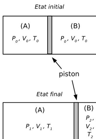
Un cylindre horizontal, de volume invariable, est fermé à ses deux extrémités par deux parois fixes. Ce cylindre est séparé en deux compartiments A et B par un piston  $\mathcal{P}$  mobile sans frottement. Les parois du cylindre et le piston sont adiabatiques et de capacités calorifiques négligeables.
