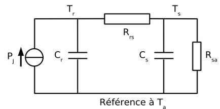
La puissance  $P_J = 100$  W est produite par effet Joule dans le rotor, les capacités thermiques du rotor et du stator sont respectivement notées  $C_r$  et  $C_s$ , les résistances thermiques valent respectivement  $R_{rs} = 0,8$  K.W<sup>-1</sup> et  $R_{sa} = 0,2$  K.W<sup>-1</sup>. La température ambiante  $T_a$  est égale à 20°C.
